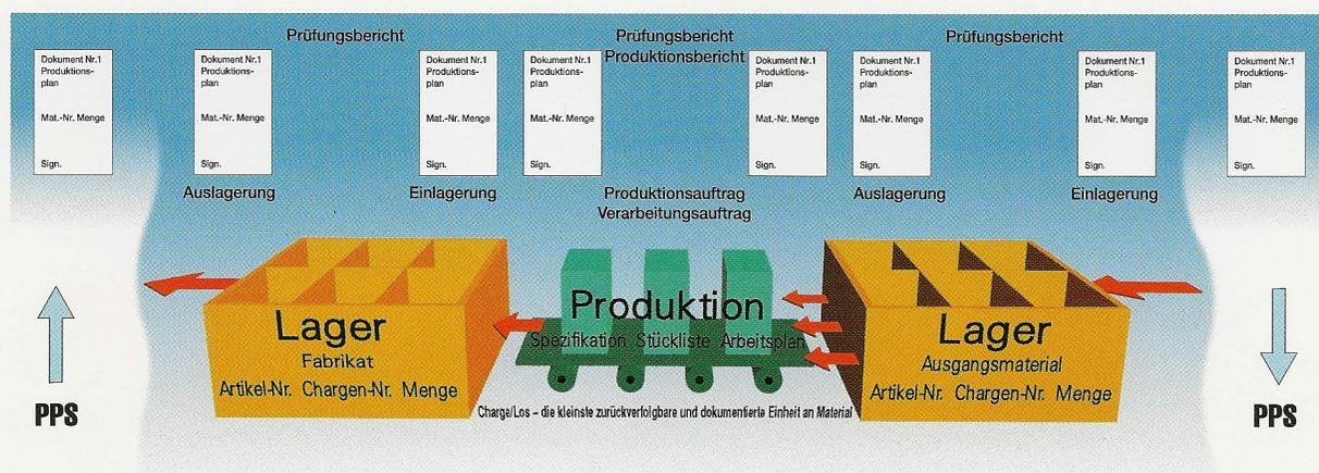
Die Abbildung der Unternehmensabläufe erfolgt anhand von Chargen (Losen, Seriennummern), die kleinsten zurückverfolgbaren und dokumentierten Einheiten an Material in der Fertigung. An eine Charge sind Qualitätsprüfungsberichte und Produktionsberichte geknüpft. Das System realisiert eine Chargenführung nach Erfordernissen des Qualitätsmanagements und gesetzlichen Bestimmungen.
